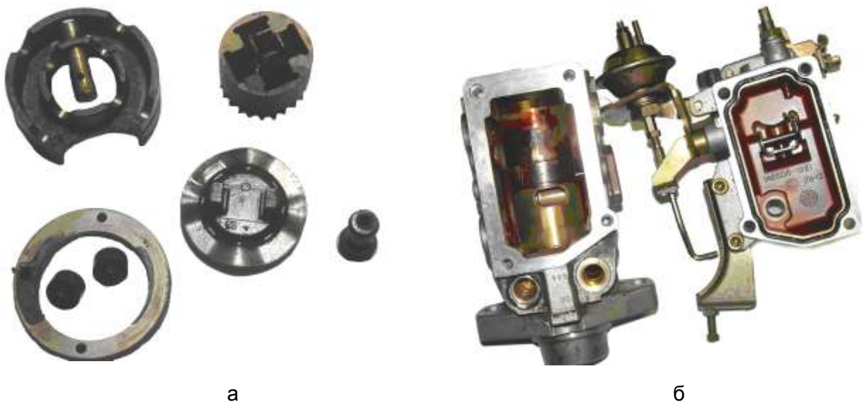
Рис.2.12. Отложения на деталях ТНВД вследствие использования топлива неадекватного качества: а - роликовая обойма, статор ТПН, грузики регулятора в обойме, кулачковая шайба, редукционный клапан ТПН; б, в - внутренние полости корпуса и крышки регулятора ТНВД.
