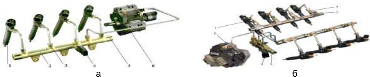
Рис. 1.89. Внешний вид автомобильной CR фирмы R.Bosch: 1 - форсунка; 2 - корпус аккумулятора; 3 - аварийный ограничитель подачи; 4 - датчик давления; 5 - предохранительный клапан; 6 - ТНВД.
