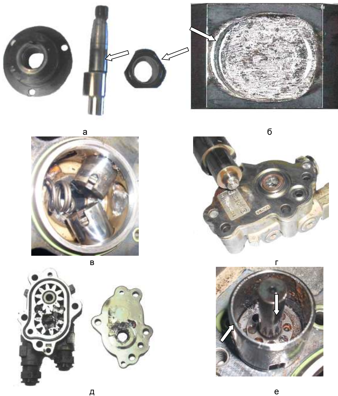
Рис.2.20. Отказы и износ деталей ТНВД системы типа Common Rail: а - кулачковый вал, эксцентрик; б - рабочая поверхность кулачка; в - блок плунжеров; г - хвостовик кулачкового вала (привод ТПН); д - шестеренчатый ТПН; е - плунжер со втулкой.
