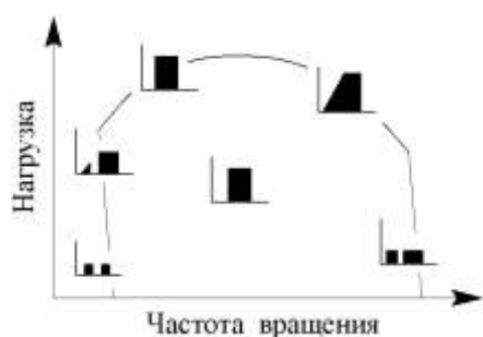
Рис. 1.133. Возможные характеристики впрыскивания топлива ТА типа HEUI-B в поле режимов работы дизеля
