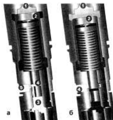
Рис. 1.135. Мультипликатор давления насос-форсунки дизеля Opel Monterey: а - запальная подача; б - основная подача; 1 - масляная полость; 2 - сервопоршень; 3 - плунжерная полость; 4 - разгрузочный канал плунжера; 5 - отсечное окно.
