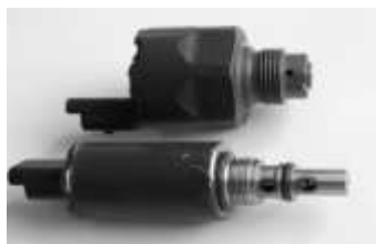
Рис. 1.93. Электроуправляемые клапаны CR Siemens: сверху - клапан давления, внизу - регулирования производительности ТНВД.
