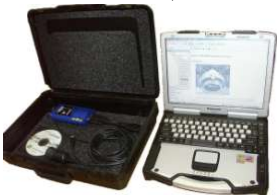
Рис.4.7. Специализированный системный тестер ADVEISER для диагностирования мобильной техники фирмы John Deere.
