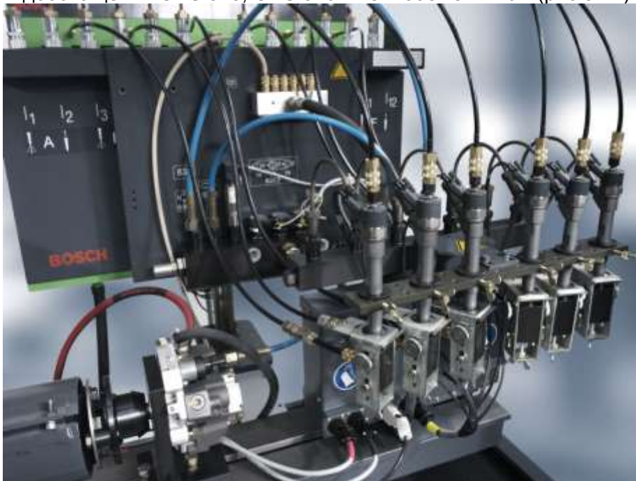
Рис.5.17. Комплекты CRS 845 и CRS 846 дооснащения стенда EPS815 для тестирования агрегатов ТПС типа CR.
