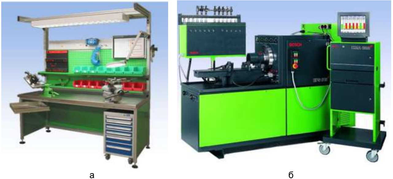
Рис.3.7. Участок рабочего места мастера-регулировщика: а – рабочий верстак; б – стенд для испытаний и регулировки ТА EPS815 с измерительной системой KMA822 фирмы BOSCH.
