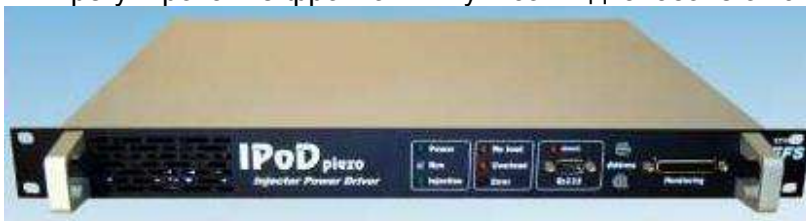
Рис.5.23. IPOD PIEZO EFS 8370 – генератор управляющих импульсов пьезофорсунок.
