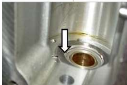
Рис.2.14. Износ втулок приводного вала и корпуса распределительного топливного насоса типа VE.
