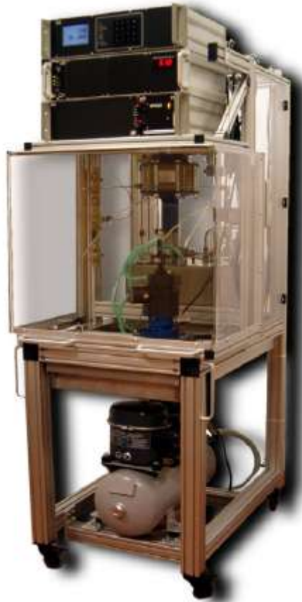
Рис.5.12. Дооснащение к топливным стендам фирмы EFS: а - стойка EFS 8330 с источником высокого давления; б - MIQ - измеритель мгновенной цикловой подачи.
