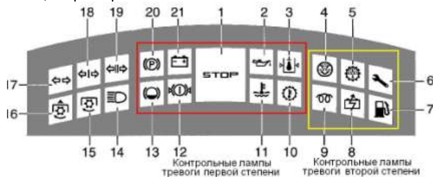
Рис.4.4. Комбинация части табло с указателями предупредительной сигнализации трактора Claas Ares 836.
