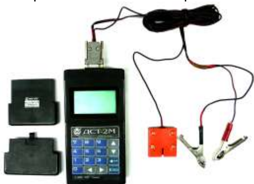
Рис.4.5. Сканер ДСТ-2М со сменными картриджами и адаптером
