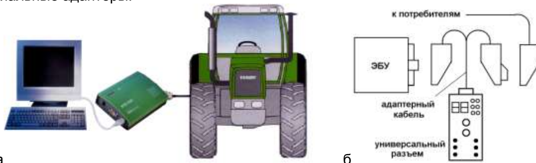
Рис.4.9. Подключение диагностического прибора через диагностический разъем (а) и адаптер (б).
